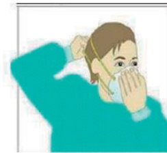
4. Pase el elástico inferior y colóquelo debajo de la oreja y sobre el cuello.
